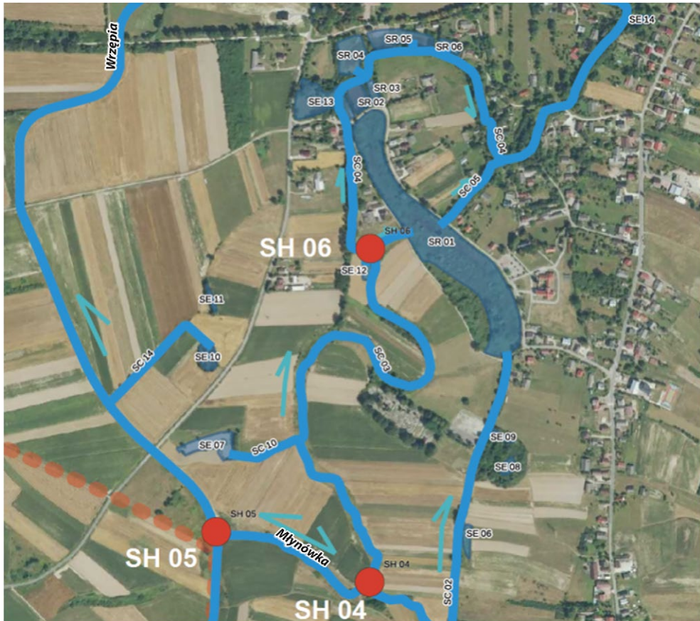
Rycina 17. Schemat dystrybucji wody – segment 3 (obiekt Strzelce Wielkie)
