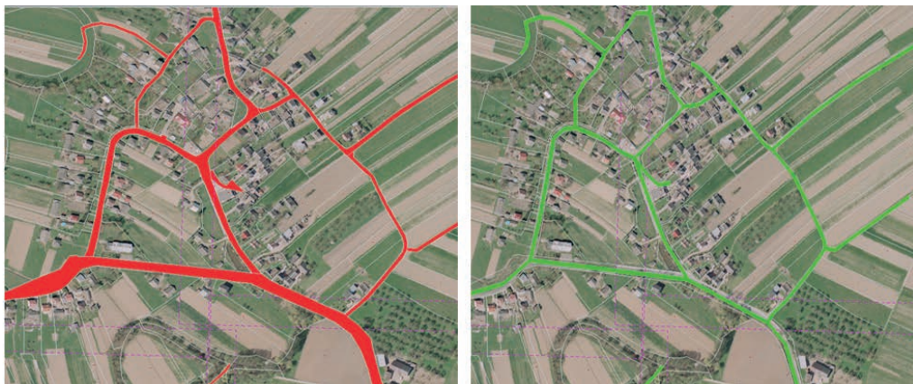
Ilustracja 6. Przykład identyfikacji zbioru wielokątów reprezentujących formalną sieć drogową (po lewej) oraz reprezentujący tę sieć graf uzyskany w procesie generalizacji (po prawej). Obiekt Strzelce Małe (źródło: opracowanie własne)
