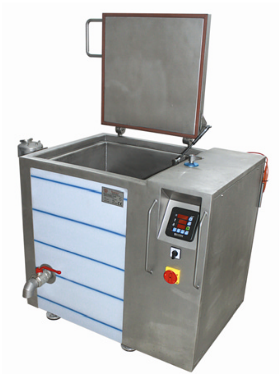
Zdj. 5. KOCIOŁ PARZELNICZY (parzenie kaszanek, salcesonów, przygotowanie kaszy do kaszanki)
