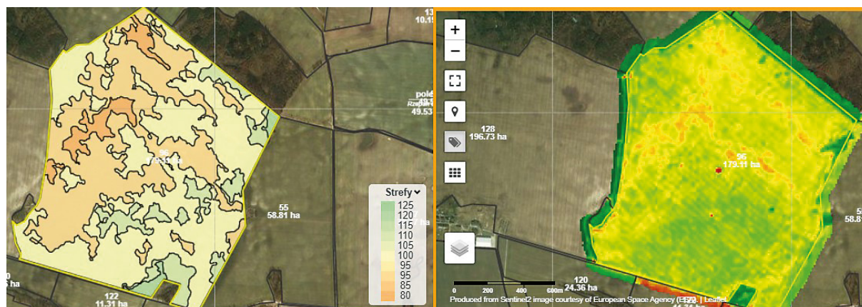
Rys. 1. Skan gleby konduktometrem elektromagnetycznym Veris 200XA (po lewej) i zdjęcie satelitarne Planet DVI pokazujące dokładnie te same strefy potencjału produkcyjnego (po prawej)
