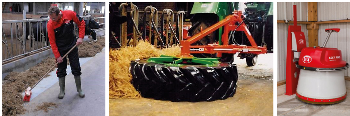
Rys. 15, 16 i 17. Zastosowanie robota Lely Juno eliminuje pracochłonną czynność ludzką, zapewniając krowom stały dostęp do paszy
