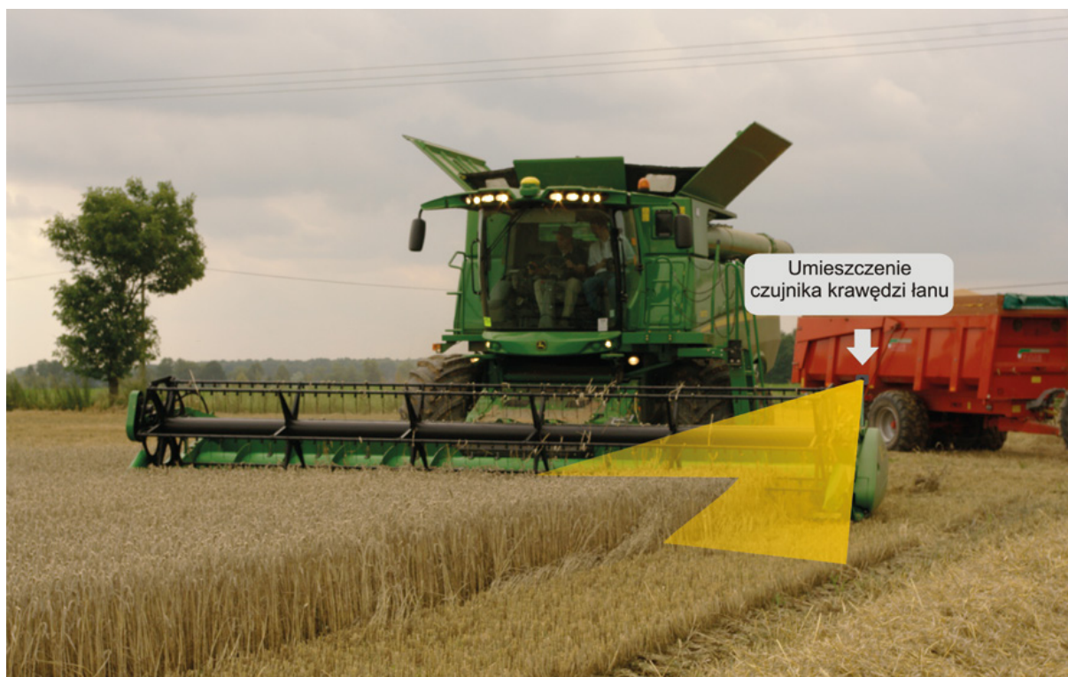
Rys. 2. Zasada kontroli przejazdu przez czujnik lidarowy zamontowany na kombajnie zbożowym
