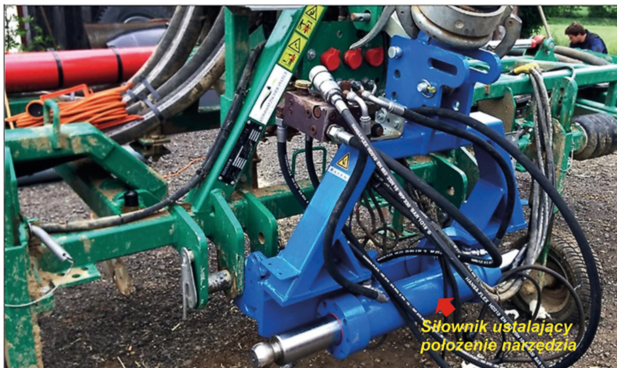
Rys. 5. System prowadzenia narzędzi za pomocą aktywnego układu zawieszania narzędzi
