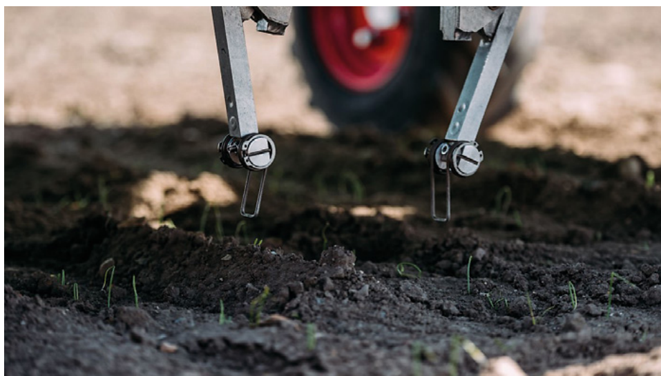
Rys. 8. Mechanizm wykonawczy robota przeznaczonego do pielęgnacji upraw rzędowych
