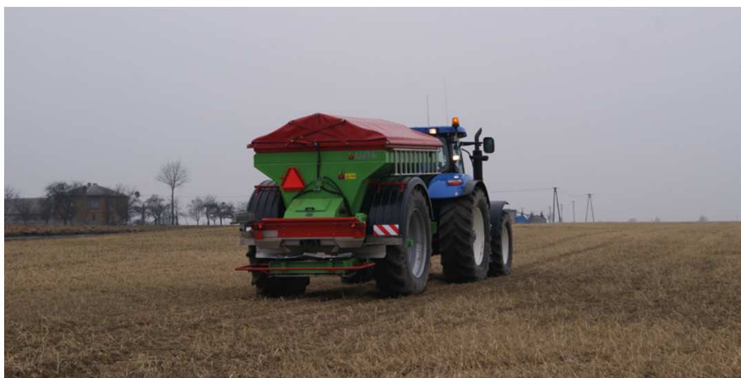
Rys. 1. Konstrukcja nowoczesnych rozsiewaczy umożliwiająca aplikowanie zmiennych dawek nawozów z wykorzystaniem nawigacji satelitarnej
