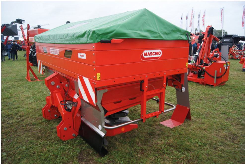
Rys. 4. Konstrukcja nowoczesnych rozsiewaczy umożliwiające aplikowanie zmiennych dawek nawozów na podstawie map aplikacyjnych
