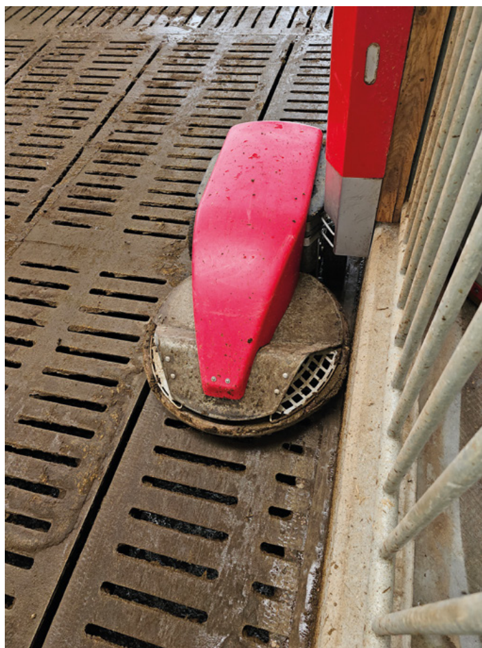
Rys. 3. Automat do czyszczenia rusztów
