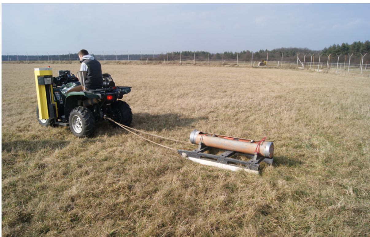
Rys. 2. Analizy z wykorzystaniem skanera elektromagnetycznego pozwalające na dokładne wyznaczenie sektorów poboru prób glebowych
