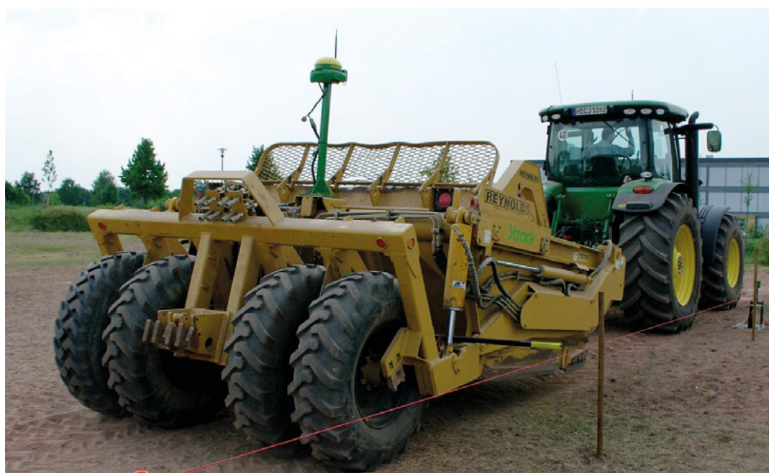
Rys. 6. Przykład rozwiązania pozycjonującego pionowe położenie narzędzia za pomocą dodatkowego odbiornika GNSS
