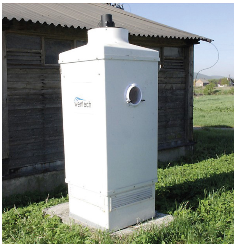
Rys. 2. Kompaktowy biofiltr do oczyszczania powietrza z chlewni
