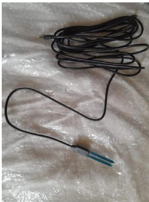
Fot. 19. Czujnik wilgotności przed instalacją w glebie (fot. E. Bolewski)
