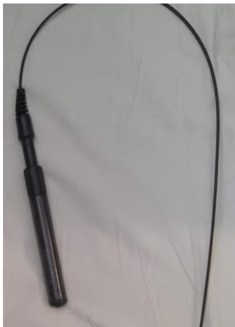
Fot. 17. Zanurzeniowy czujnik poziomu wody wraz z kablem bezpośredniego odczytu danych pomiarowych (fot. E. Bolewski)
