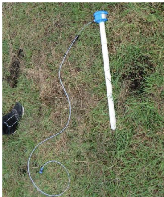
Fot. 19. Czujnik wilgotności przed instalacją w glebie (fot. E. Bolewski)
