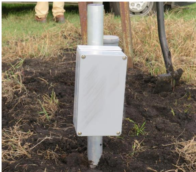
Fot. 21. Rejestrator danych wilgotności gleby z możliwością zdalnego przesyłu danych, zamknięty w kropłoszczelnej obudowie (fot. E. Bolewski)
