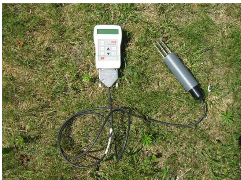
Fot. 18. Przenośny zestaw do pomiaru wilgotności gleby (sonda wilgotności i czytnik) (fot. E. Bolewski)
